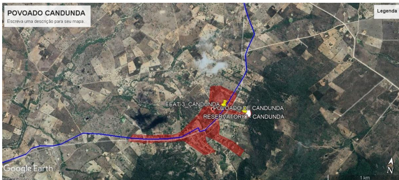
Figura 8 - Povoado Candunda (661487.00 m E de longitude e 8959806.00 m S de latitude em coordenadas UTM – 24L). No perímetro do povoado deverá ser instalado uma EEAT e uma Reservatório. Posteriormente, (cerca de 6,7km e 7,9km) estão previstas duas Travessias em linhas de drenagem com curso d'água efêmero. Fonte: Encibra.
